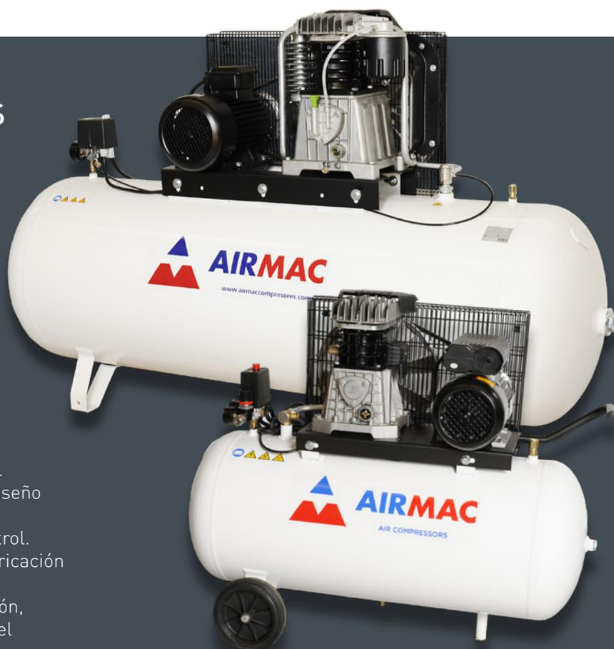
También disponemos de la versión en tándem de la serie Airmac, la cual nos permite obtener compresores de pistón de hasta 20 Hp, ahorrando así en los mantenimientos y garantizando un considerable ahorro de energía, debido a la utilización de unidades de control electromecánicas para la gestión de la máquina y arrancadores estrella / triángulo.
